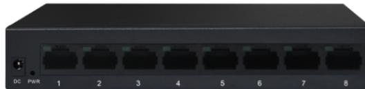
Switch de réseau à 8 ports gigabit.
