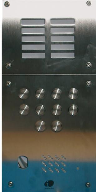
Platine en inox A316L, 4mm d'épaisseur - Tableau porte noms séparé, touches gravées. Double grille de protection du groupe audio - La platine de rue doit être complétée d'un HP-micro selon le système de câblage utilisé - Eclairage par lampes navettes 6.3x39 art 1172(non fournies - Prédiseignée pour lecteur Vigik (empreinte T25)- Fixation par vis antivandale - 4 boutons d'appel -Dimensions platine: 180x340 mm - Dimensions boîtier: 160x320x50 mm
