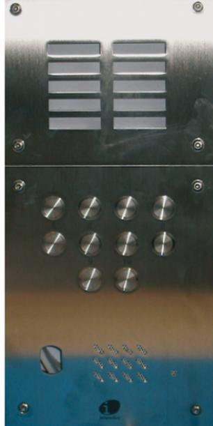
Platine en inox A316L, 4mm d'épaisseur - Tableau porte noms séparé, touches gravées. Double grille de protection du groupe audio - La platine de rue doit être complétée d'un HP-micro selon le système de câblage utilisé - Eclairage par lampes navettes 6.3x39 art 1172(non fournies - Prédiseignée pour lecteur Vigik (empreinte T25)- Fixation par vis antivandale - 6 boutons d'appel - Dimensions platine: 180x340 mm - Dimensions boîtier: 160x320x50 mm
