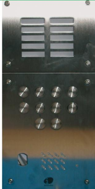
Platine en inox A316L, 4mm d'épaisseur - Tableau porte noms séparé, touches gravées. Double grille de protection du groupe audio - La platine de rue doit être complétée d'un HP-micro selon le système de câblage utilisé - Eclairage par lampes navettes 6.3x39 art 1172(non fournies - Prédiseignée pour lecteur Vigik (empreinte T25)- Fixation par vis antivandale - 24 boutons d'appel - Dimensions platine: 300x330 mm - Dimensions boîtier: 280x310x50 mm
