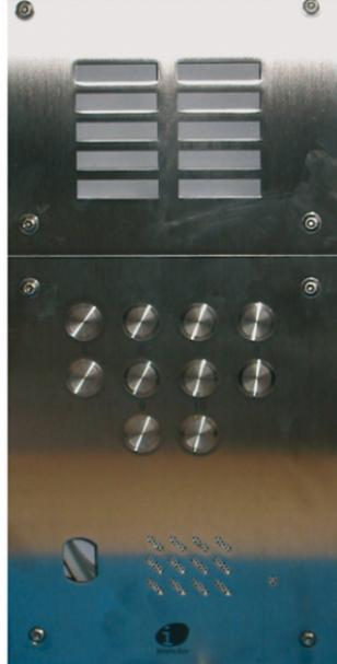
Platine en inox A316L, 4mm d'épaisseur - Tableau porte noms séparé, touches gravées. Double grille de protection du groupe audio - La platine de rue doit être complétée d'un HP-micro selon le système de câblage utilisé - Eclairage par lampes navettes 6.3x39 art 1172(non fournies - Prédiseignée pour lecteur Vigik (empreinte T25)- Fixation par vis antivandale - 32 boutons d'appel - Dimensions platine: 300x390 mm - Dimensions boîtier: 280x370x50 mm
