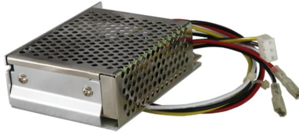
Alimentation switching Open Frame, chargeur de batterie PB, entrée 90÷260 VAC / 50÷60 Hz, sortie 13.8 VDC / 5 A. Dimensions (L x H x P) 157 x 36 x 95 mm. Certifiée EN50131-6 niveau 2.
