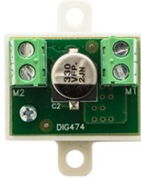
Adaptateur de tension système Simplebus 2. À utiliser dans des installations avec alimentation 1210/1210A. Pour alimenter les centrales de type ACMR et variantes. Remplace l'ancienne référence art. SK9015
