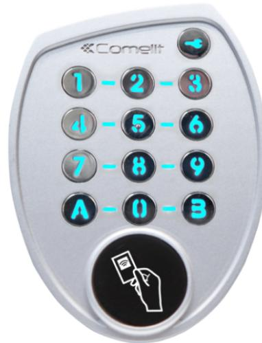
Clavier à codes en zamak, 100 codes de 3 à 6 caractères, touches rétroéclairées. Avec lecteur de proximité intégré. 500 badges, paramétrage par apprentissage. Relais paramétrables en mode monostable 1 à 99 secondes ou bistable. Gestion BP d'entrée, horloge et alarme. Gestion Wiegand. Ouverture par code ou par badge ou par code et badge Possibilité de relais externe. - 25°à+50° C, IP54, IK10. Dimensions 122 x 90 x 19 mm
