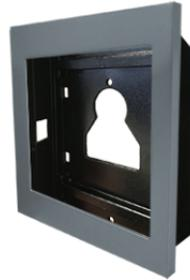
Châssis à encastrer 1 module pour platine Ultra. Comprend un support métallique permettant de fixer solidement les modules sans besoin de vis et un cadre réalisé en aluminium moulé sous pression traité par cataphorèse pour augmenter la résistance à la corrosion chimique et environnementale, y compris aux rayons UV. Épaisseur 10 mm. Peut être utilisé sur les boîtiers à encastrer art. 3110/1 et 3110/1A avec possibilité d'aligner horizontalement plusieurs modules. Dimensions: 125,5x136x35mm
