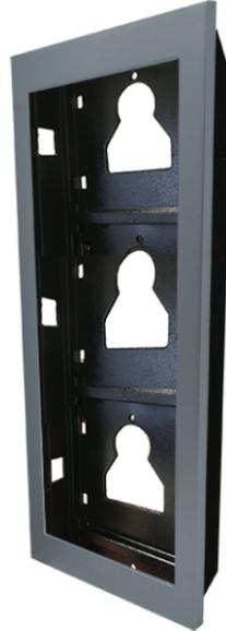
Châssis à encastrer 3 modules pour platine Ultra. Comprend un support métallique permettant de fixer solidement les modules sans besoin de vis et un cadre réalisé en aluminium moulé sous pression traité par cataphorèse pour augmenter la résistance à la corrosion chimique et environnementale, y compris aux rayons UV. Épaisseur 10 mm. Peut être utilisé sur les boîtiers à encastrer art. 3110/3 et 3110/3A avec possibilité d'aligner horizontalement plusieurs modules. Dimensions: 125,5x317,5x35mm
