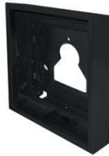
Boîtier en saillie 1 module pour platine Ultra, noir RAL9005. Il est composé d'un support métallique qui permet de fixer fermement les modules sans utiliser de vis et d'un cadre en aluminium moulé sous pression traité par cataphorèse servant à augmenter la résistance aux processus de corrosion chimique et environnementale, y compris les rayons UV. Saillie de 35 mm par rapport au mur. Dimensions (L x H x P) : 110 x 107 x 35 mm.
