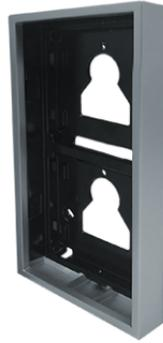
Boîtier en saillie 2 modules pour platine Ultra. Comprend un support métallique permettant de fixer solidement les modules sans besoin de vis et un cadre réalisé en aluminium moulé sous pression traité par cataphorèse pour augmenter la résistance à la corrosion chimique et environnementale, y compris aux rayons UV. Épaisseur 35 mm.
