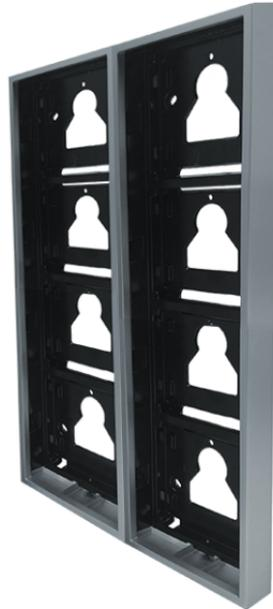
Boîtier en saillie 8 modules (2 supports de 4 modules côte à côte) pour platine Ultra. Comprend un support métallique permettant de fixer solidement les modules sans besoin de vis et un cadre réalisé en aluminium moulé sous pression traité par cataphorèse pour augmenter la résistance à la corrosion chimique et environnementale, y compris aux rayons UV. Épaisseur 35 mm. Le câble qui assure la connexion des modules est compris. Dimensions: 221x380x35mm
