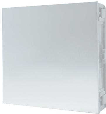
Module obturateur version Full Metal pour platines Ultra, blanc RAL9016. Revêtement en alliage d'aluminium anodisé. Dimensions (L x H x P) : 100 x 90 x 35 mm.
