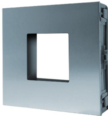
Module disposant d'un logement pour les unités de contrôle d'accès de tiers pour platine Ultra. Orifice 40 x 40 mm. Revêtement en alliage d'aluminium anodisé. Compatible avec les lecteurs GS3 encastrables Comelit PAC. Dimensions: 100 x 90 x 35mm. REMARQUE: la compatibilité mécanique avec un lecteur tiers encastrable doit être vérifiée pour différents modèles
