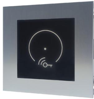
Module vide destiné à loger des unités de contrôle d'accès de tiers pour platine Ultra. Section frontale noire 60,5 x 60,5 mm. Revêtement en alliage d'aluminium anodisé. Dimensions (L x H x P) : 100 x 90 x 35 mm REMARQUE : la compatibilité mécanique des lecteurs avec montage à panneau de tiers doit être contrôlée et vérifiée pour les différents modèles !
