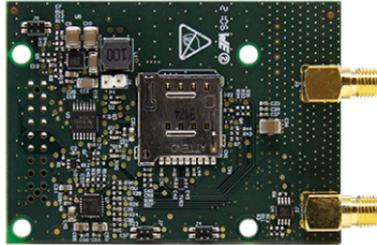
Le module d'extension de la communication GSM Art. VEDOGSM4G permet de faire des appels téléphoniques, d'envoyer des SMS, des MMS et des mails sur le réseau connecté, d'envoyer des protocoles numériques et de synchroniser la date et l'heure. Associé à la carte des messages vocaux art. VEDOVOICE, il permet le contrôle à distance de la centrale via transmetteur vocal. Le module assure également la connexion à travers l'appli Comelit. Livré avec deux antennes comprises.
