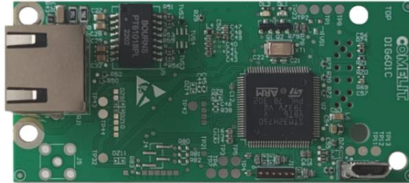
Carte d'extension connectable pour la communications sur réseau Ethernet TCP/IP pour centrales série Vedo. Permet d'interagir à distance pour la gestion de la centrale et la mise à jour du micrologiciel de la centrale, des claviers, des lecteurs de proximité et des modules entrées/sorties. Serveur web intégré. EN50131 grade 2.
