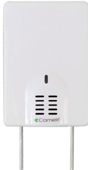
Détecteur d'inondation, boîtier en ABS blanc, alimentation 12 Vcc, consommation 20 mA en alarme, 15 mA en veille, longueur bornes externes max 35 mm, sortie à relais sélectionnable NF/NO, possibilité de relier jusqu'à 8 détecteurs à distance dans un rayon maximum de 100 mètres, dimensions 60x90x25mm.
