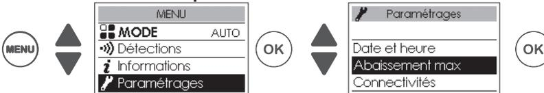
Permet de régler le niveau d'abaissement maximum de la température que vous souhaitez effectuer lors de vos périodes d'absences (de -2° C à -4° C). Par défaut, il est réglé à -3° C.
