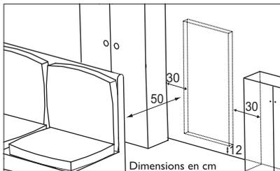
Respectez les distances minimales avec le mobilier pour l'emplacement de l'appareil. Ne pas installer d'étagère au-dessus des appareils verticaux.
