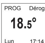
Vous pouvez modifier la température ECO, vous forcez donc le réglage par défaut entre la température Confort et la température Eco. «PROG Dérog.» s'affiche jusqu'à la prochaine plage Confort. Vous pouvez régler l'écart entre la température Confort et Eco dans le menu «Abais. T° ECO» (voir chapitre «Le menu en mode PROG»).
