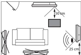
Pour optimiser la détection d'absence, de votre appareil, évitez de l'installer dans un angle fermé ou derrière un meuble.
