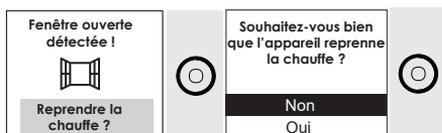
La chauffe de l'appareil reprendra si vous la réactivez en sélectionnant «Oui» sur l'interface de commande ou si l'appareil détecte une augmentation significative de la température. Après la reprise de la chauffe, l'appareil reprendra son rythme en fonction du mode défini initialement (manuel ou programmation).
