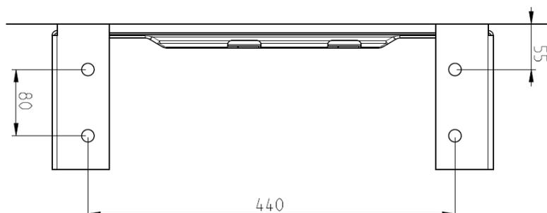
3 – Une fois les supports solidement fixés au plafond, serrer les écrous maintenant l'étrier aux supports de plafond.
