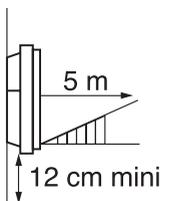
La détection ne se fait pas en dessous du capteur.
