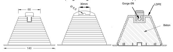
Matière lest : Béton résistant au froid (XF2) +
