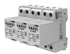
La valeur limp=25kA par pôle permet une installation au TGBT de bâtiments équipés de paratonnerre suivant NFC15-100/C15-443. Compatible avec les systèmes paratonnerre de niveau I à IV suivant NF EN 62305-3 et en fonction du nombre de pôles et de circuits. Le niveau de protection Up 1.5kV, permet une protection Type 1 / Type 2 sans coordination.
