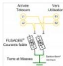
FUSADEE cartouche parafoudre de remplacement pour parafoudre lignes téléphonie analogique 3kW, diamètre 11mm x 38mm hauteur, Up = 0,25kV, coloris jaune
