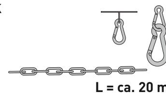
(de) Achten Sie bei der Auswahl der bauseitigen Befestigungsmittel auf die **5-fache Sicherheit (Leuchtengewicht + Deckenbefestigung)**.
