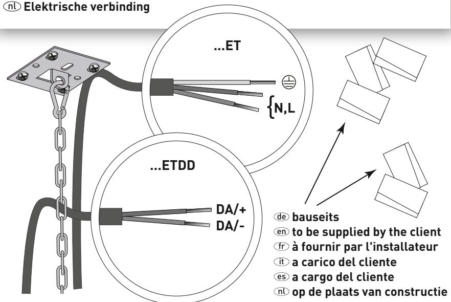
(de) Die Leuchte kann mittels Netzanschlussklemmen z.B. BJB Typ. 46.411.7000 mit dem Versorgungsnetz verbunden werden. Alternativ kann eine Steckverbindung z.B. Typ Wieland Gesis RST 20i3 verwendet werden.
