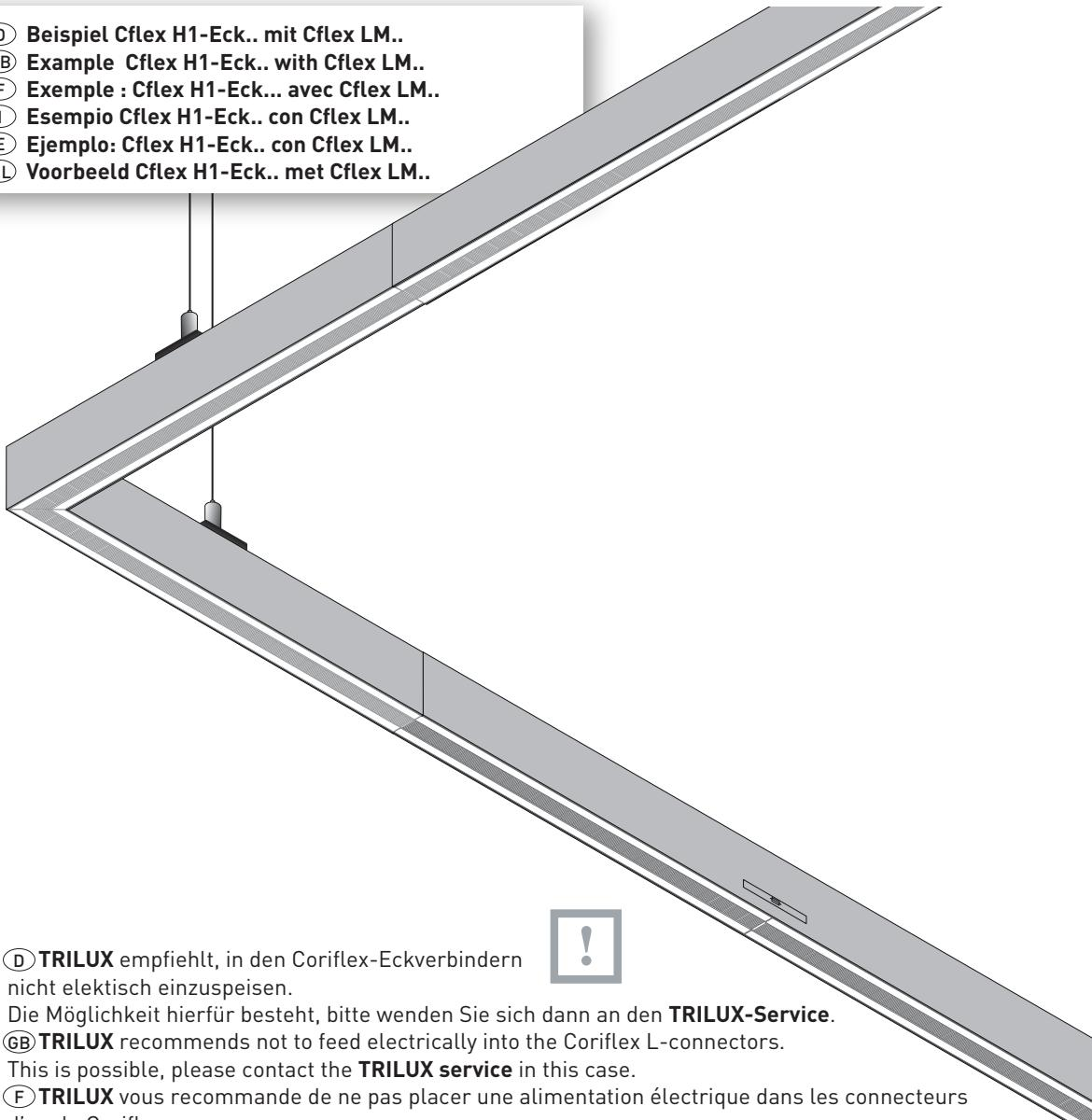
(D) **TRILUX** empfiehlt, in den Coriflex-Eckverbindern nicht elektrisch einzuspeisen.
