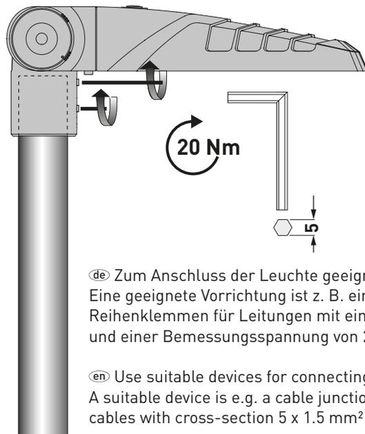
Ⓣ Zum Anschluss der Leuchte geeignete Vorrichtungen verwenden. Eine geeignete Vorrichtung ist z. B. ein Kabelübergabekasten mit Reihenklammern für Leitungen mit einem Querschnitt von 5 x 1,5 mm<sup>2</sup> und einer Bemessungsspannung von 250/400 V.
