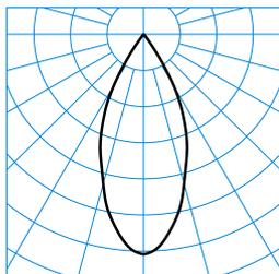
**E-Line 7651 B.VEO RFS-WFL 05 50-840 J17 ET L37 01 (225) TX57528** ■ C0 - C180
