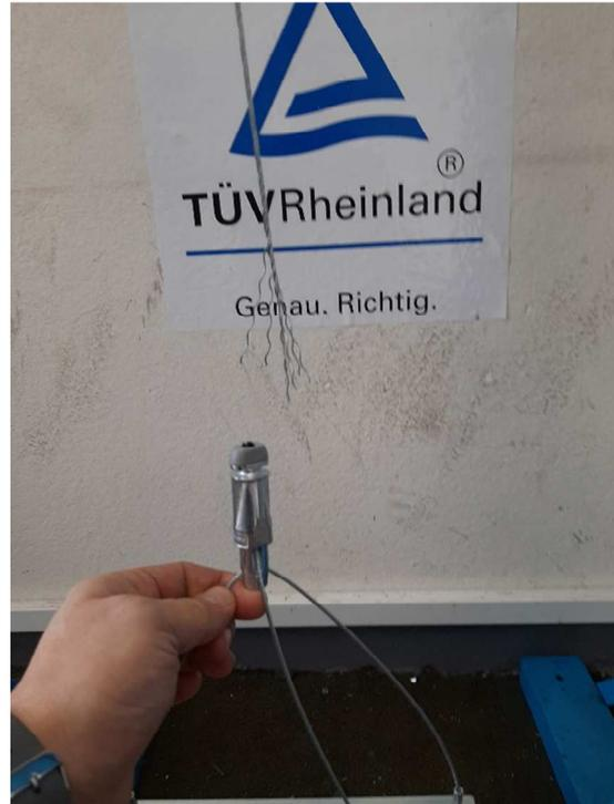
Abbildung 28: Versuchsaufbau UniGrip Y-Pipe
