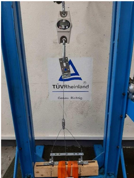
Abbildung 23: Versuchsaufbau UniGrip Y-Pipe
