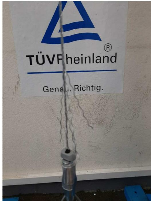
Abbildung 18: Versuchsaufbau UniGrip Y-Pipe mit Endung „Gewinde“ und 17mm Abstand
