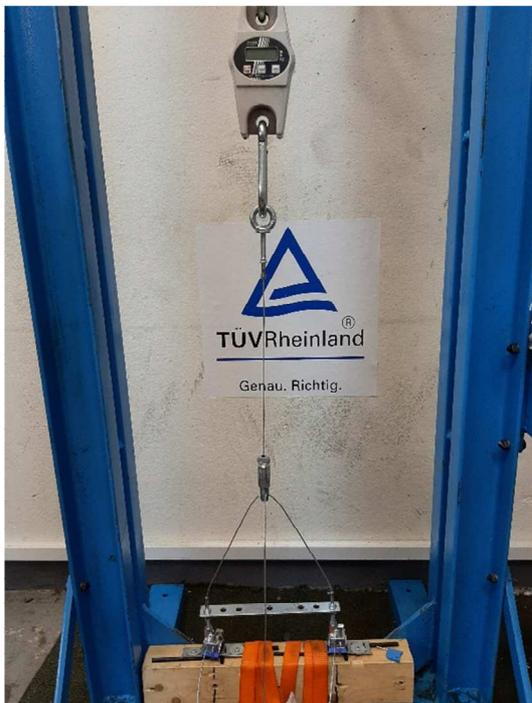
Abbildung 19: Versuchsergebnis UniGrip Y-Pipe mit Endung „Gewinde“ und 17mm Abstand
