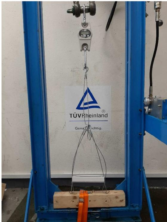
Abbildung 9: Versuchsaufbau Direct Fix Clip double
