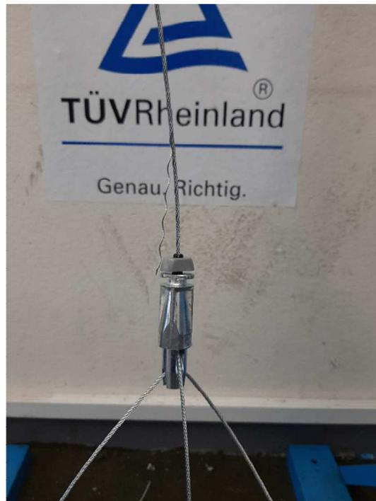
Abbildung 32: Versuchsaufbau UniGrip Y-Pipe
