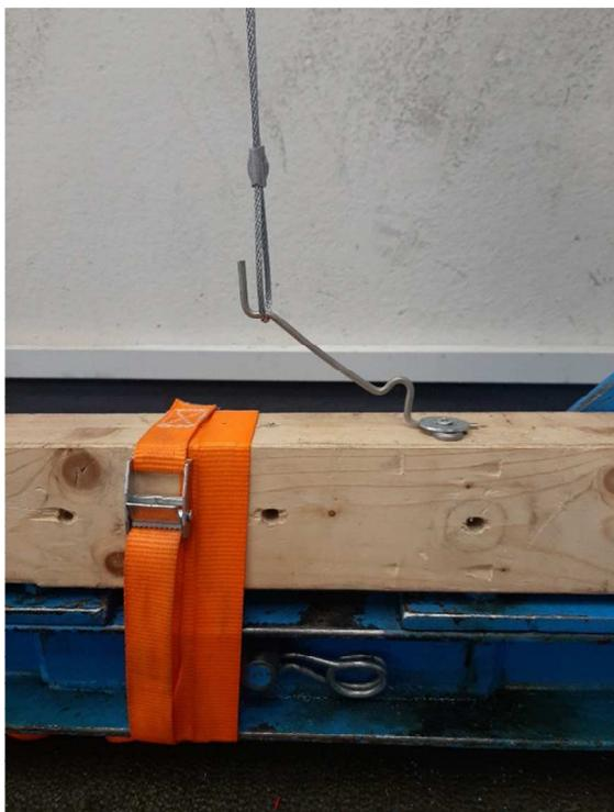
Abbildung 8: Versuchsaufbau Direct Fix Clip double
