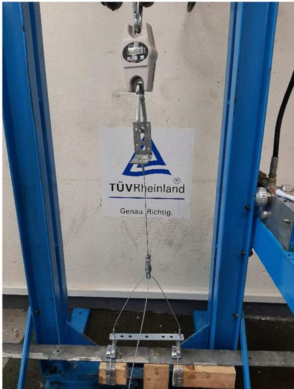
Abbildung 37: Versuchsaufbau UniGrip Y-Pipe
