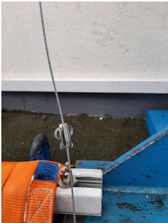
Abbildung 16: Versuchsaufbau UniGrip Y-Pipe mit Endung „Schlaufe“ und 17mm Abstand
