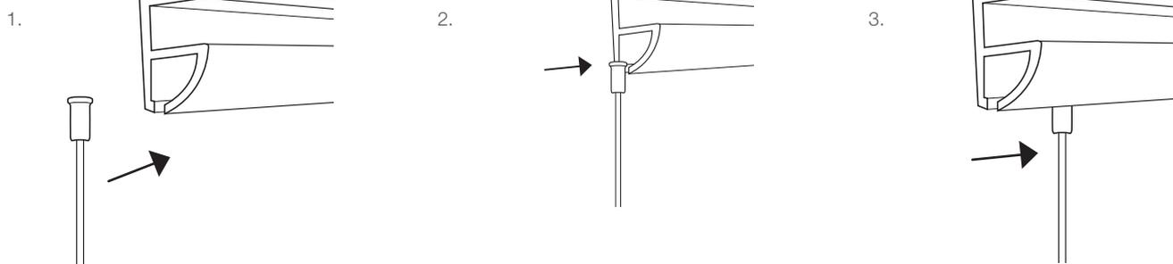
Glissez l'embout stop dans le rail jusqu'à la position souhaitée.
