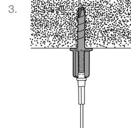
3. Étape 3 – Visser l'embout fileté M8 ou M10 d'une clé à choc avec un couple de serrage maximum de 150 Nm
