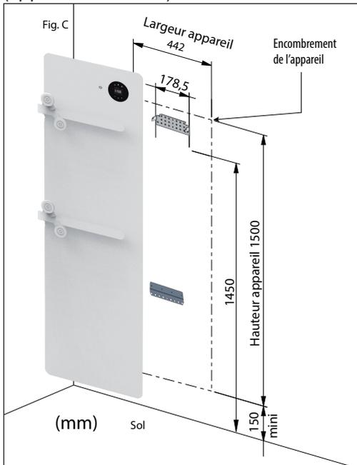
**1** - Repérer les trous de fixation de la pièce supérieure sur le mur, percer, cheviller et visser cette pièce (choix des chevilles et des vis en fonction de la nature de votre mur et du poids de l'appareil). Vérifier l'horizontalité de la pièce une fois fixée.
