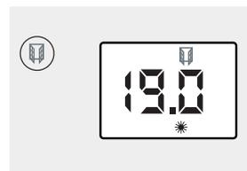
*i* Cette fonction arrête automatiquement le chauffage en cas de détection d'une chute brutale de la température dans la pièce (Ex : une fenêtre ou une porte ouverte).
