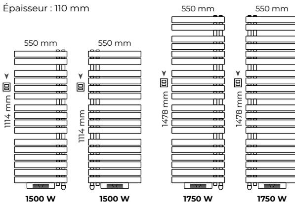
► Emplacement du boîtier de commande sur l'appareil
