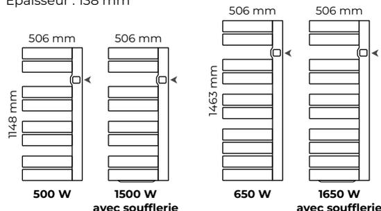
► Emplacement du boîtier de commande sur l'appareil
