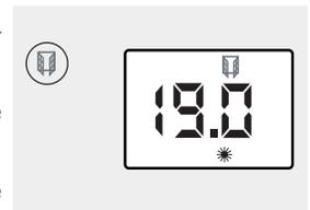
*Cette fonction arrête automatiquement le chauffage en cas de détection d'une chute brutale de la température dans la pièce (Ex : une fenêtre ou une porte ouverte).*
