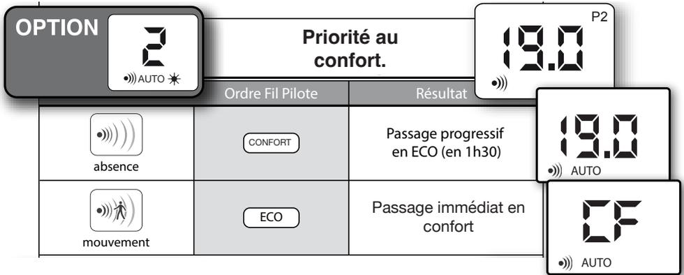
*Passage progressif en ECO : En cas d'absence prolongée, la consigne de température de l'appareil diminue progressivement par paliers de 30min en CF-1 puis CF-2, jusqu'à l'affichage d'ECO.*
