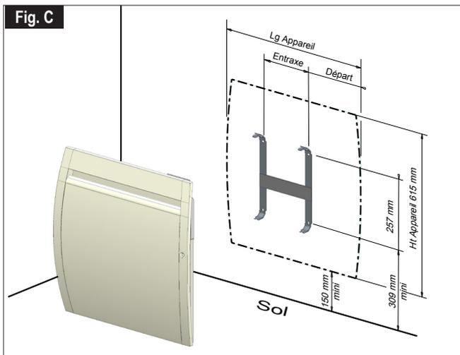
s'assurant de l'orienter dans le bon sens et à la bonne hauteur (Fig. C) et (Fig.D).
