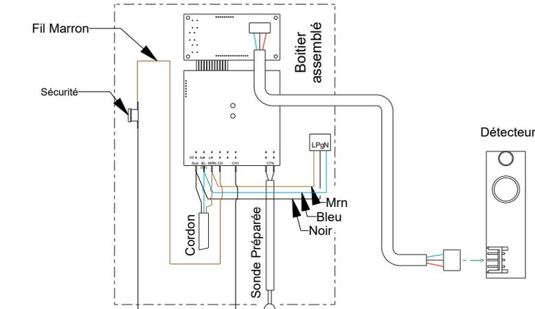
Schéma de Cablage de 750 à 2000W (Elts en parallèle)
