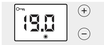
*i* Cette fonction permet de bloquer l'accès aux réglages de l'appareil afin d'empêcher toute modification intempestive. La touche Marche / Arrêt chauffage demeure active, même quand le verrouillage parental est activé.
