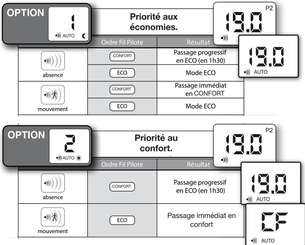
**i** Passage progressif en ECO : En cas d'absence prolongée, la consigne de température de l'appareil diminue progressivement par paliers de 30min en CF-1 puis CF-2, jusqu'à l'affichage d'ECO.
