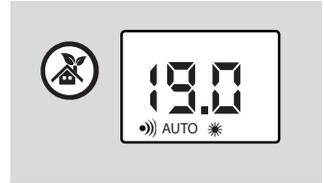
En cas d'absence prolongée, l'appareil diminue progressivement sa consigne de température. Lorsqu'il détecte une présence, il réagit et revient dans le mode de fonctionnement défini par l'utilisateur.
