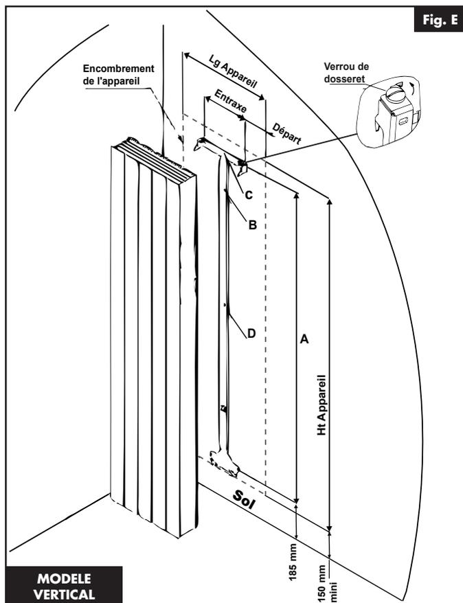
■ Déverrouiller le dossieret en agissant à l'aide d'un tournevis sur les verrous dans le sens des aiguilles d'une montre puis ôter le dossieret de l'appareil (Fig.E).
