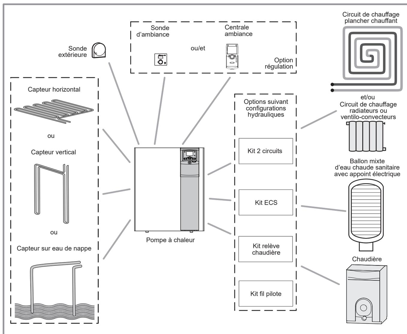
figure 1 - Vue d'ensemble d'une configuration d'installation complète
