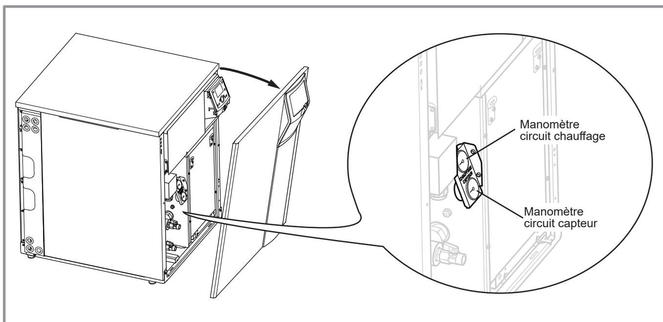
figure 6 - Accès aux manomètres
