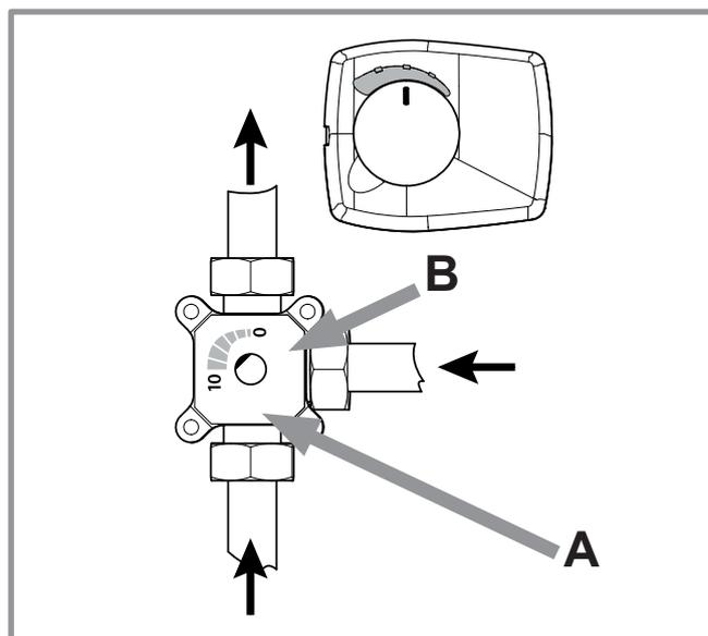
figure 7 - Montage du servomoteur
