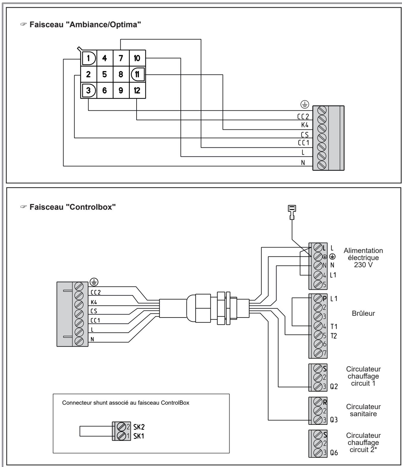
figure 9 - Câblage des faisceaux de puissance (Ambiance BTX 4100, Ambiance 4100, Optima 4100)
