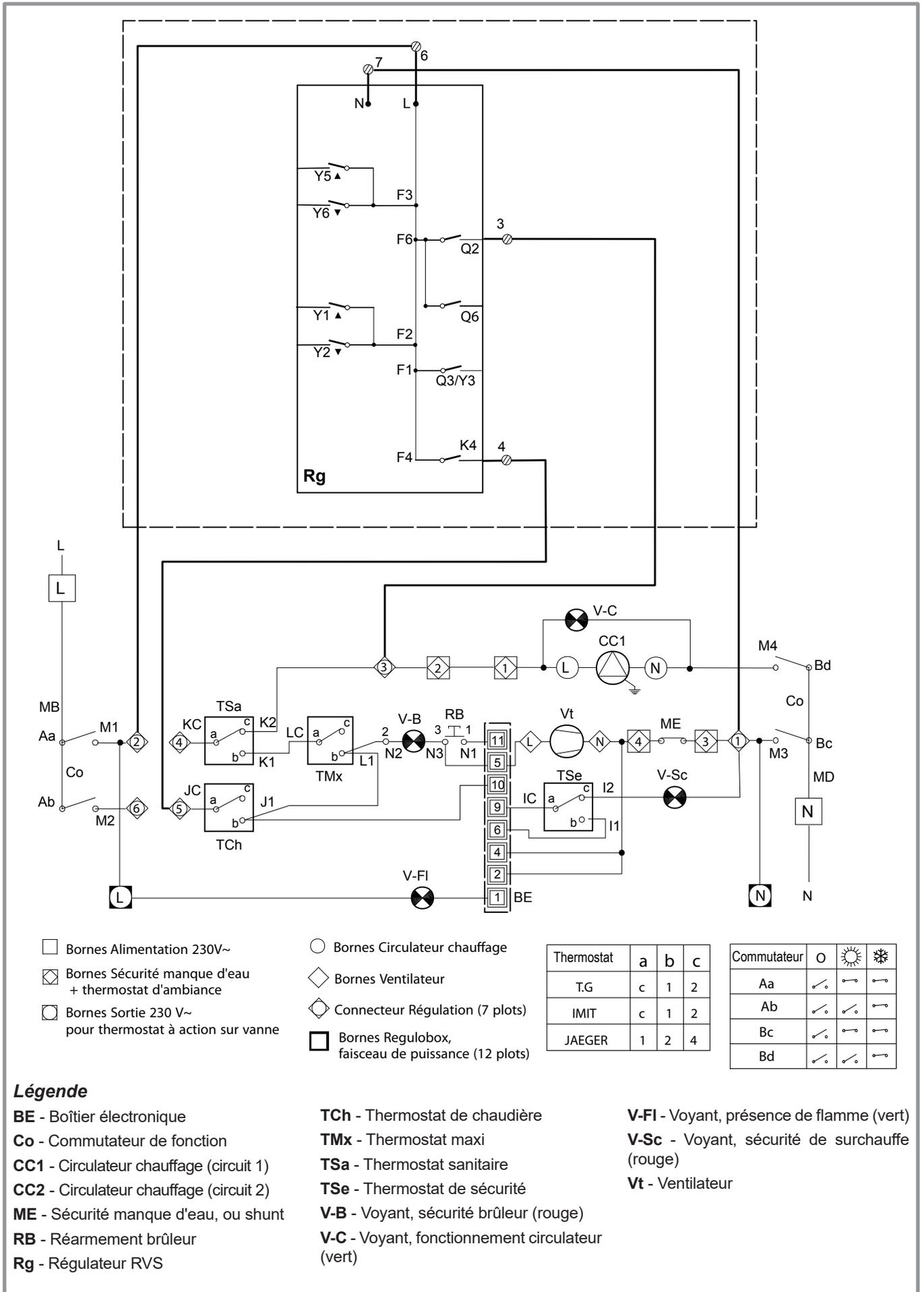
figure 17 - Schéma électrique avec Optimagaz 3000
