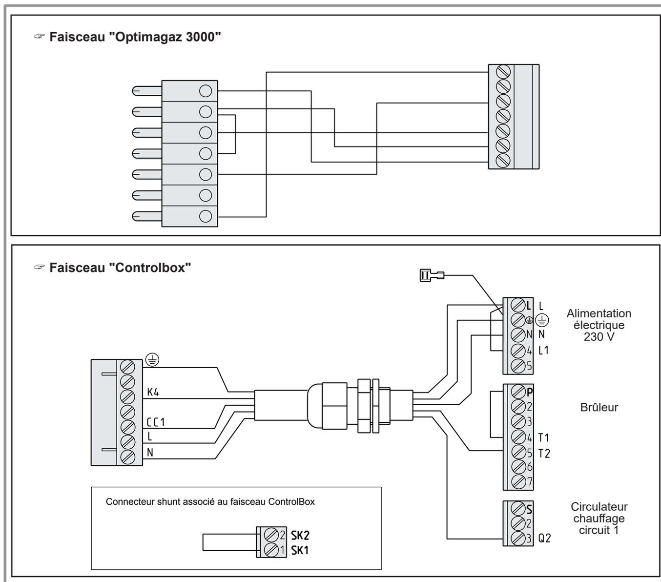
figure 16 - Câblage des faisceaux de puissance (Optimagaz 3000)
