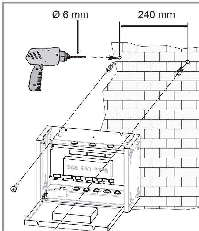
figure 5 - Installation du boîtier
