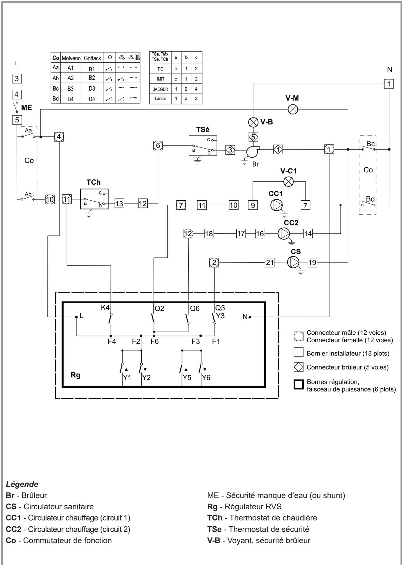
figure 11 - Schéma électrique avec Optima 4100
