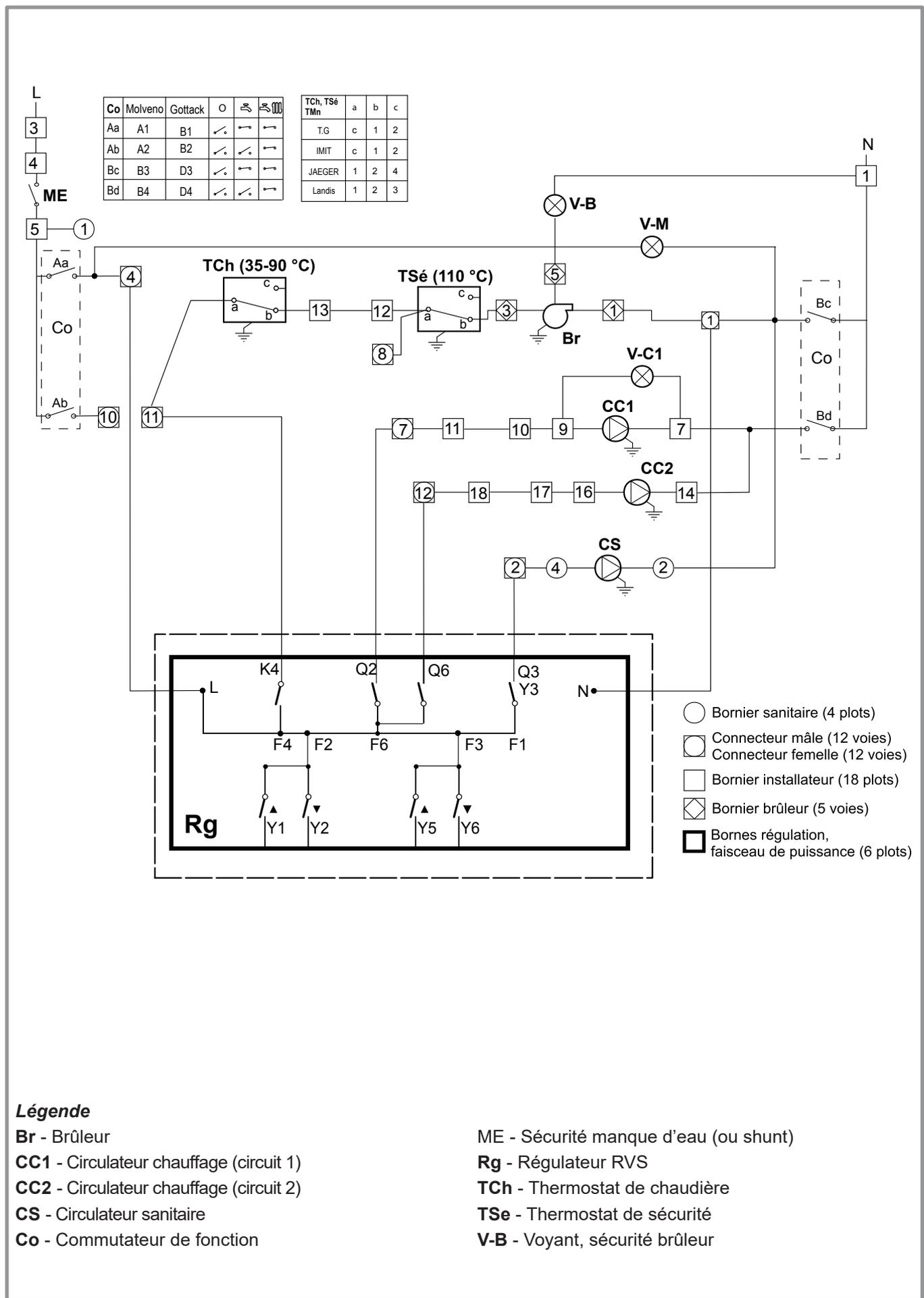
figure 10 - Schéma électrique avec Ambiance BTX 4100, Ambiance 4100
