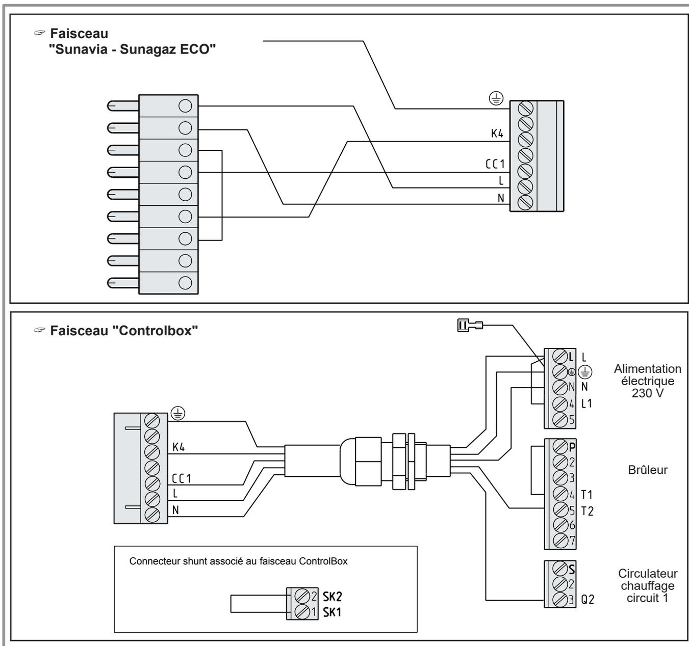
figure 13 - Câblage des faisceaux de puissance (Sunavia 5000 - Sunagaz Eco 4000)
