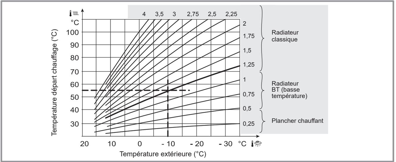
figure 22 - Pente de chauffage (ligne 720)
