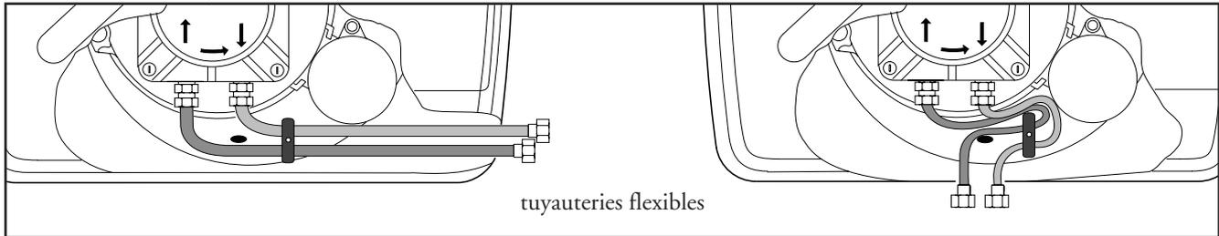
La garantie de bon fonctionnement du brûleur implique qu'un filtre (60 µm) soit bien installé sur la tuyauterie d'alimentation fioul. Le brûleur est équipé d'origine du bouchon de dérivation B1 pour raccordement bitube (fig.4).
