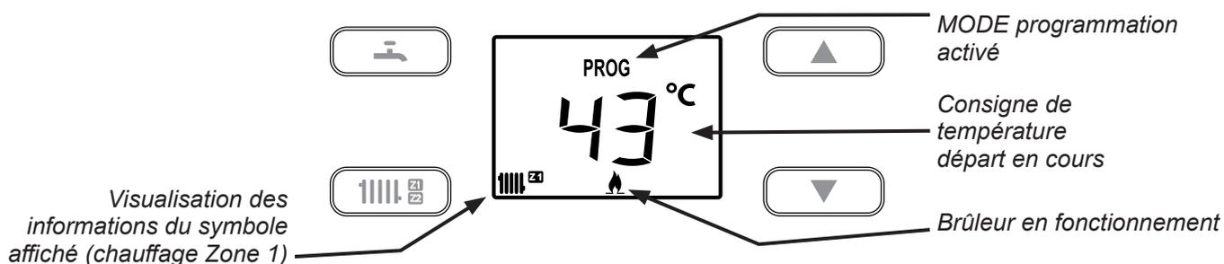
fig. 2 - Interface utilisateur (exemple d'affichage de base)
