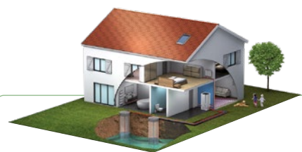
Captage eau de nappe
