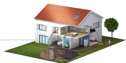
Captage sur sonde géothermique
