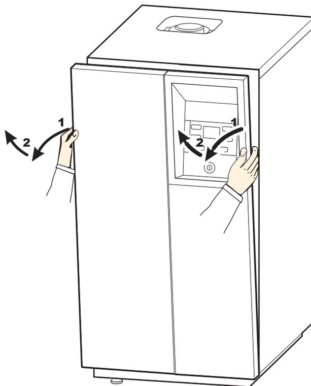
fig. 4 - Perfinox 2 - Ouverture de la chaudière
