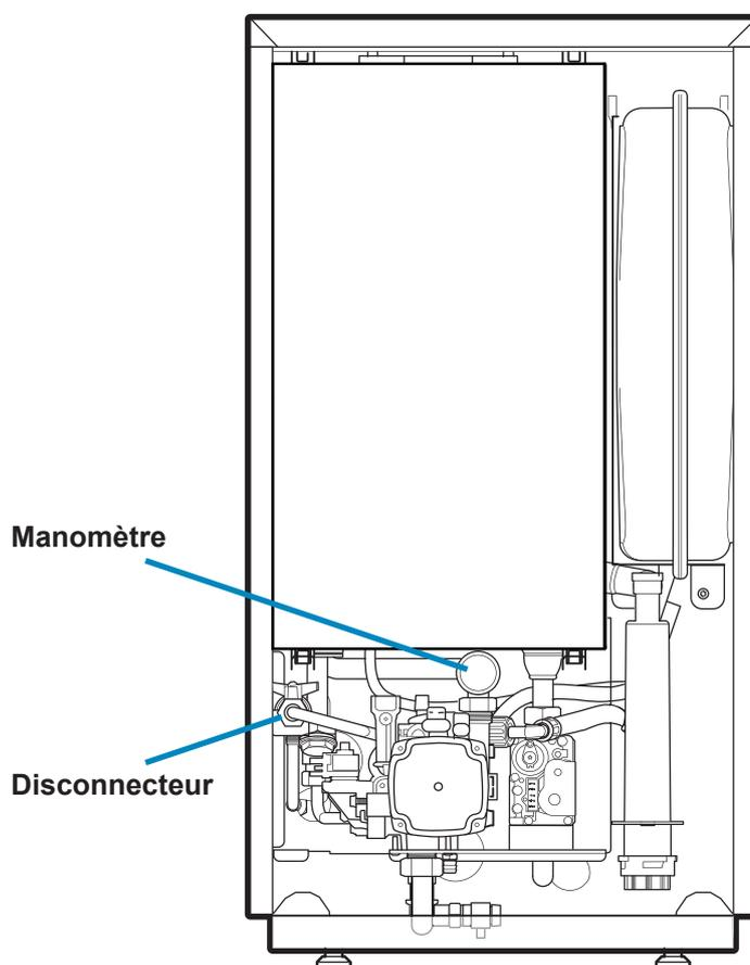
fig. 5 - Perfinox 2 - Emplacement du disconnecteur
